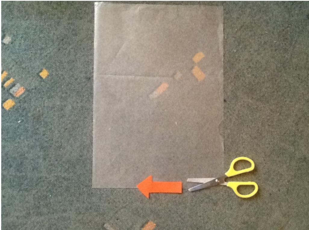
Nun sind zwei A3-Folien entstanden, die man aufeinander legt und an den drei im Bild markierten Seiten mit der untersten Stufe des Folienschweißgerätes zusammen schweißt.
